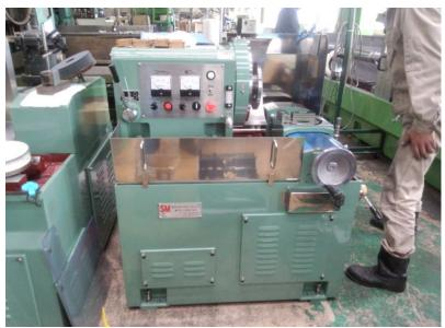
当社のお客様へ 野口工機株式会社製の砥石ドレス機を 納入させて頂きました。 この機械を使い円筒研削盤等で使用する 砥石を機外で成型する事により 本機の加工時間を長くする事が出来ます。 貴社工場の生産性向上の一助につながればと思っています。 有難う御座いました。
